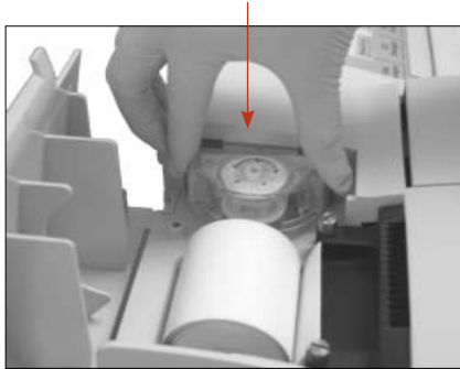
Figure I-3 : Installation de la nouvelle cartouche de pompe
