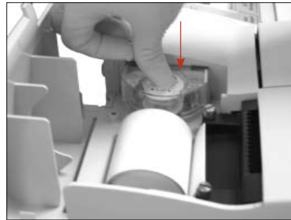
Figure I-4 : Poussez le galet de roulement de la pompe vers le bas
