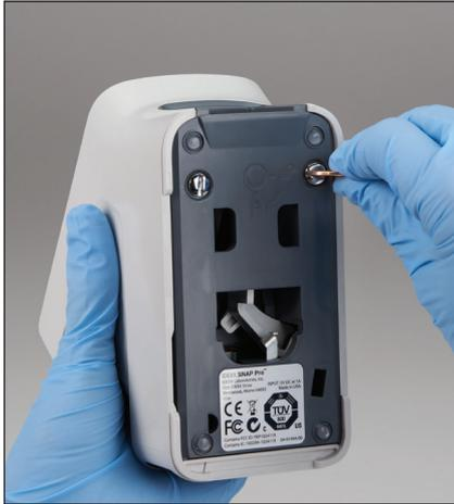
7. Tournez les attaches en argent d'un quart de tour dans le sens des aiguilles d'une montre pour verrouiller la base en place.
